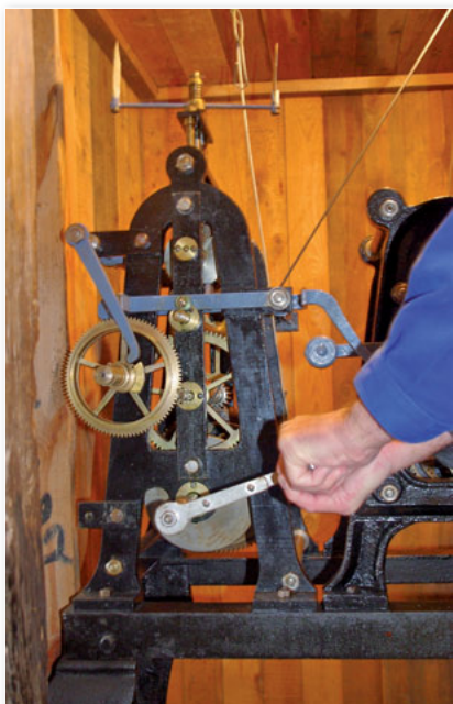
2 x wöchentlich zieht Küster Klaus Manteufel den Mechanismus der Glocken auf, hier den der Gebetsglocke
